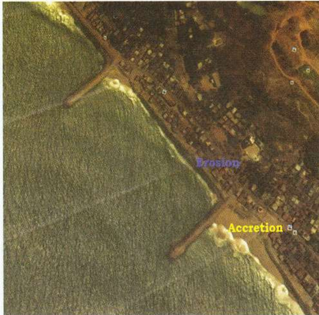
ग्रीन समुद्र या नदी के किनारे लंबवत निर्मित एक कठोर हाइड्रोलिक संरचना
